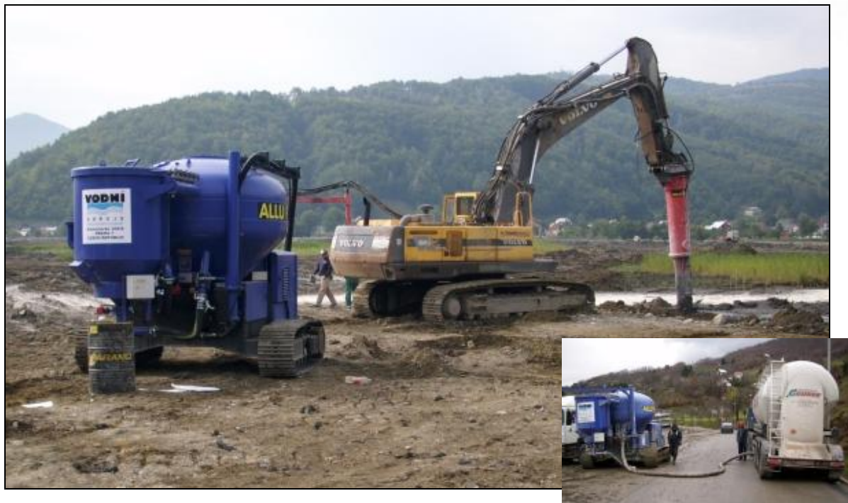
ALLU PF (6 m3) a ALLU PM-500 na rypadlu VOLVO EC 450 na lokalitě Mojkovac (MNE)
